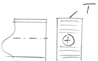
Der IPE 200-Träger knickt in y-Richtung seitlich aus, sobald die (konst.) Temperaturerhöhung  $45,5^\circ$  erreicht, (rein rechnerisch bei idealen Material- und Systemparametern). Die Normalspannung liegt mit
