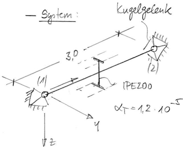
Ein "perfekt" gerader Stab wird zwischen zwei Auflagerpunkten in der Längsrichtung fixiert.
