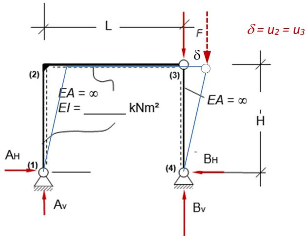
Das System wird um ein noch unbestimmtes Maß schiefgestellt, so dass die Last  $F$  mit dem Hebelarm  $\delta$  um den Auflagerknoten (4) wirken kann.
